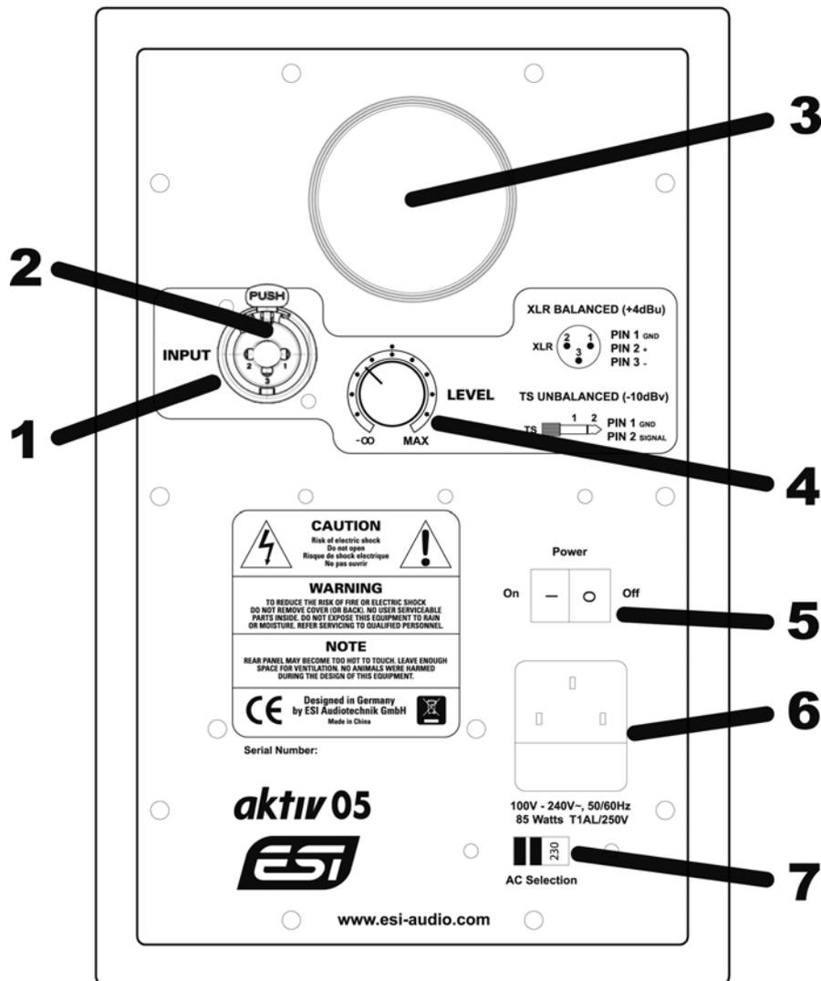
**1. XLR-Eingang** – dieser Anschluss ermöglicht die Verbindung Ihrer Quelle über symmetrische XLR-Kabel (+4dBu). Die Pinbelegung:
